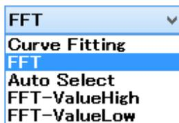
膜厚計算式を **FFT**・**Curve Fitting** から選択します。 **Auto Select** を選択した場合はデータを分析し、自動で **FFT** か **Curve Fitting** かを判断します。
